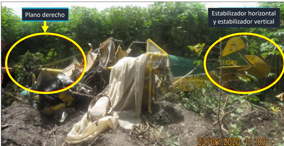
Fotografía No. 13 - Estado (integral) del plano derecho y empenaje.
