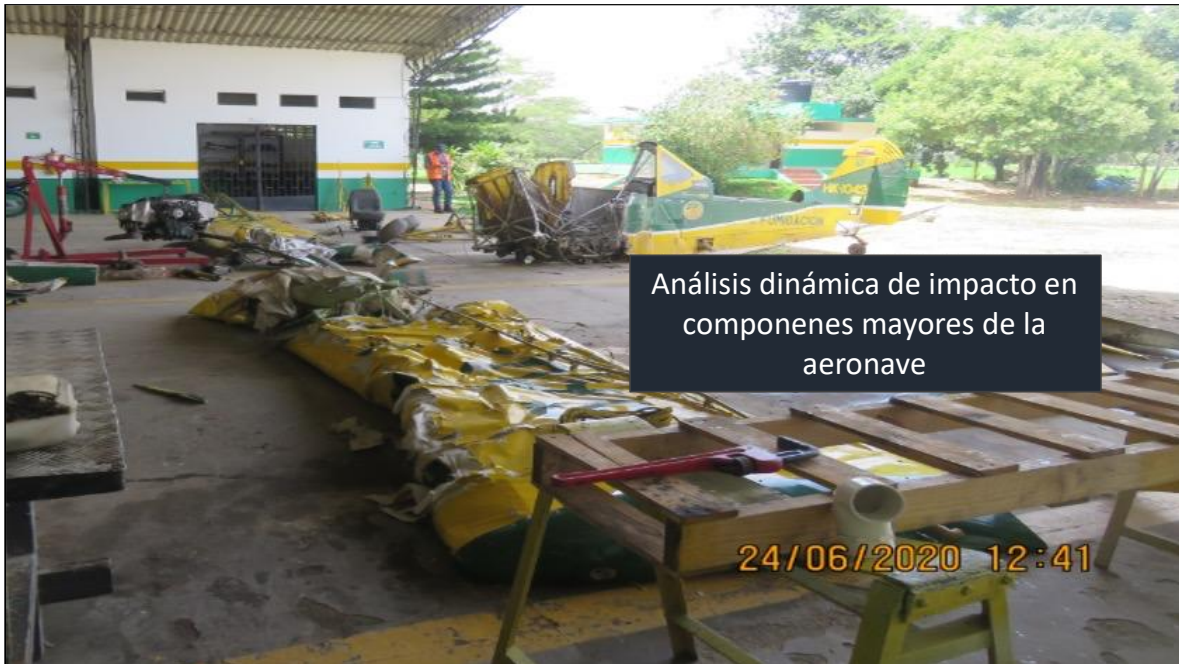
Fotografía No. 14 – Reconstrucción de la aeronave para analizar la dinámica de impacto.
