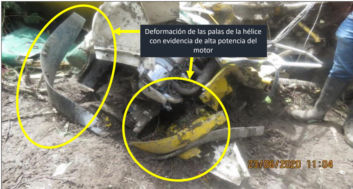
Fotografía No. 12 – Daños en las palas de la hélice.
