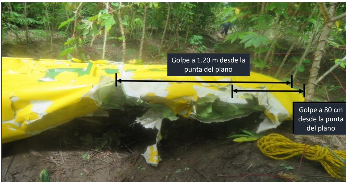
Fotografía No. 11 - Golpe contra el borde de ataque del plano izquierdo.
