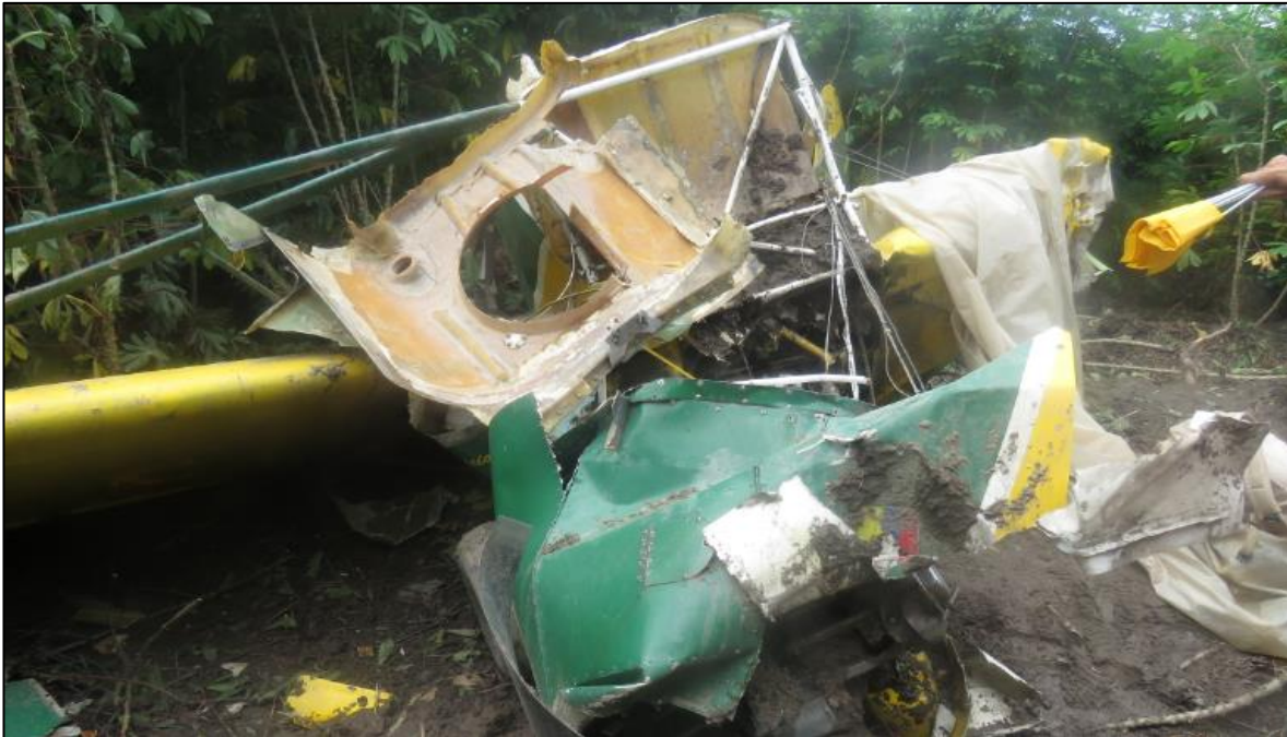
Fotografía No. 5 - Fracturas sustanciales del fuselaje.
