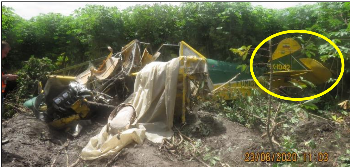
Fotografía No. 7 - Daños empenaje zona 300.
