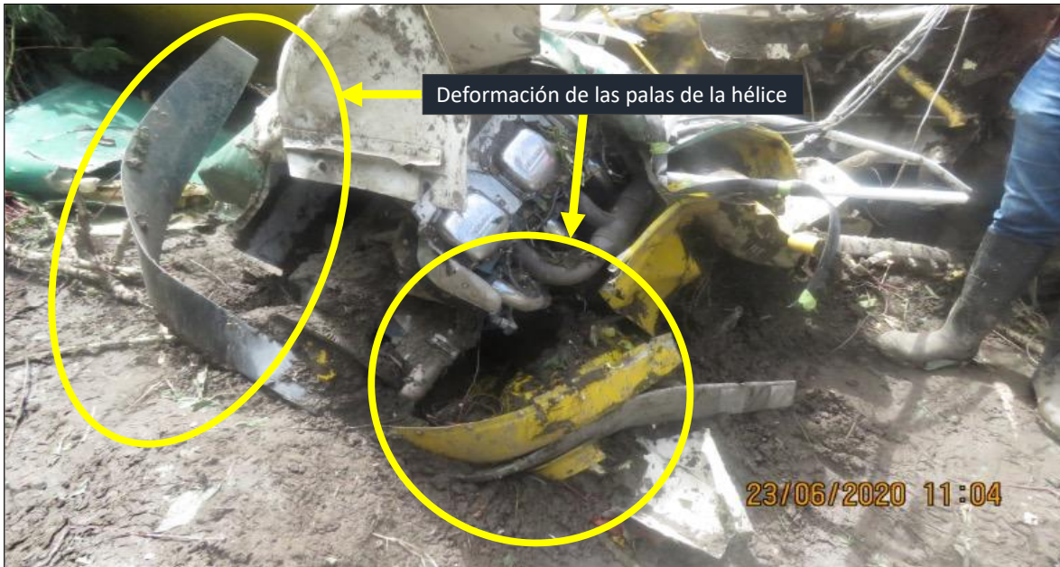
Fotografía No. 8 - Daños en motor y hélice zona 400.
